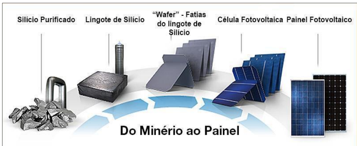
Figura 5 – Do minério ao painel “Construção”
